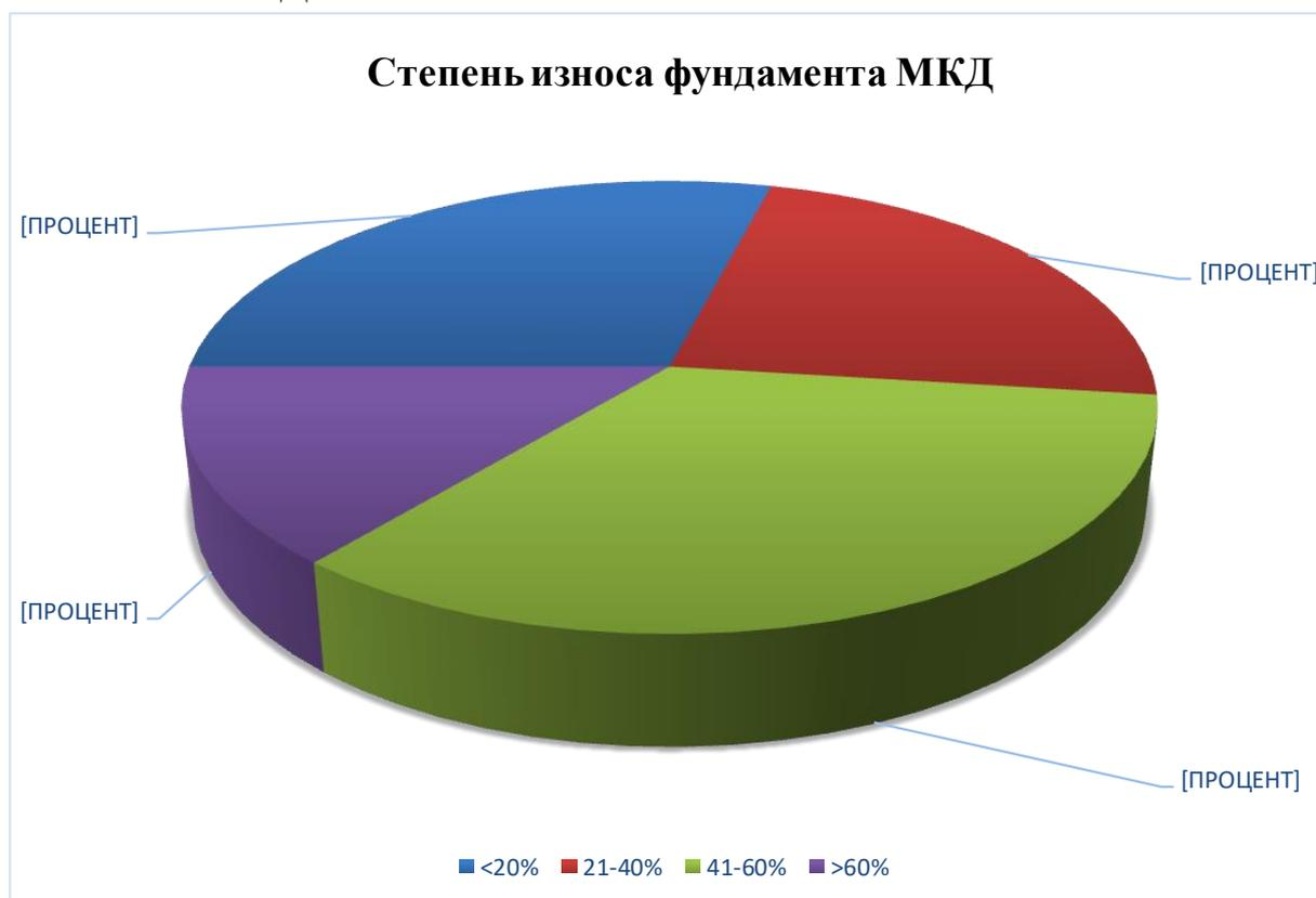
Согласно проведенному анализу, в 4901 МКД фундаменты имеют степень износа более 40%, т.е. только при выполнении ремонта возможна дальнейшая эксплуатация объекта.
