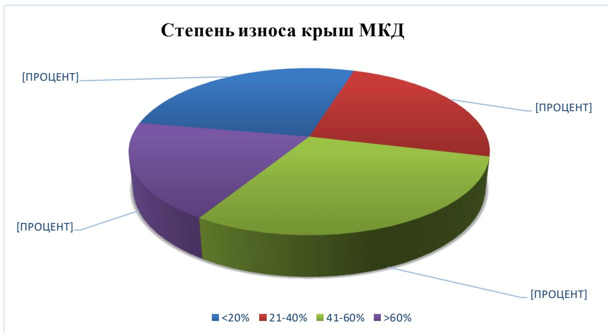
Согласно проведенному анализу, в 4830 МКД крыши имеют степень износа более 40%, т.е. только при выполнении ремонта возможна дальнейшая эксплуатация объекта.
