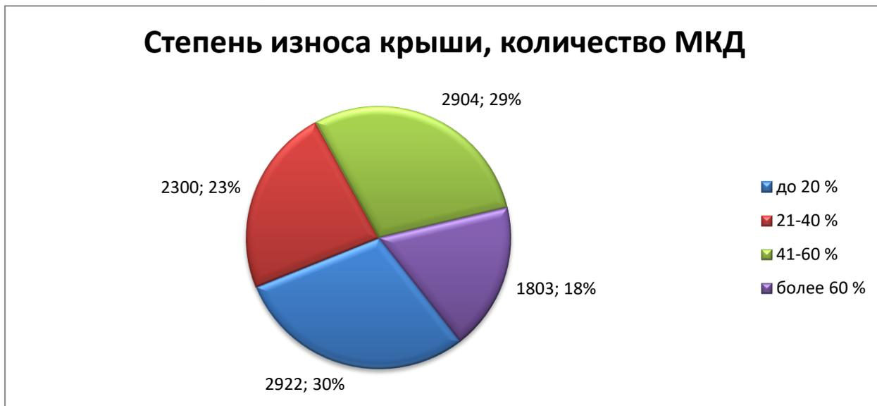
Согласно проведенному анализу, в 4704 МКД крыши имеют степень износа более 40%, т.е. только при выполнении ремонта возможна дальнейшая эксплуатация объекта.
